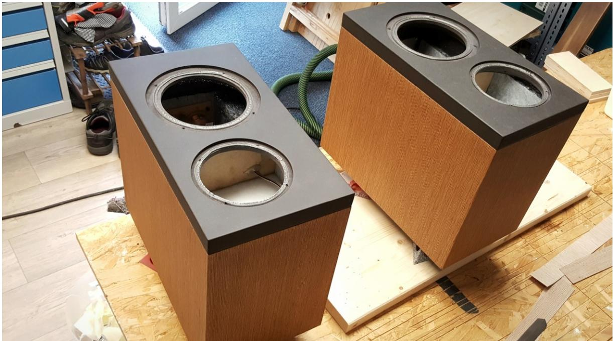
*Abbildung 24: Oberflächenbehandlung der Gehäuse mit Hartwachsöl*
