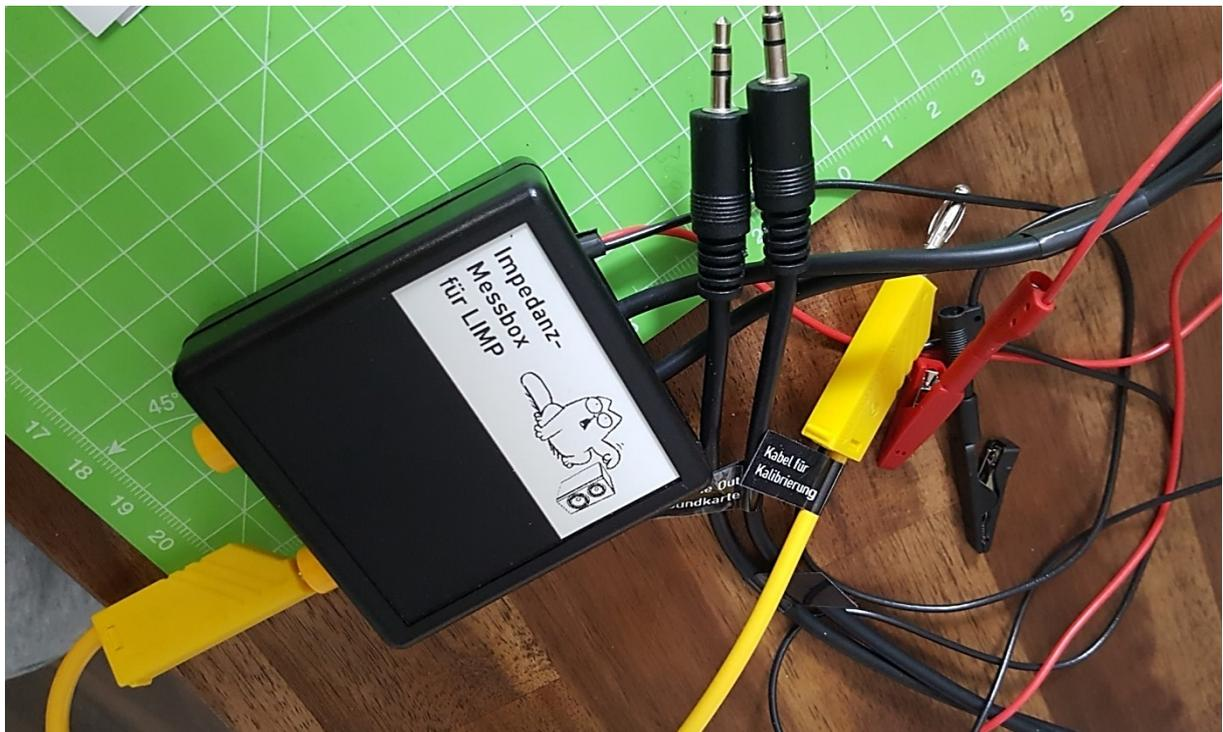
Abbildung 26: LIMP-Impedanz-Messbox mit eindeutiger Beschriftung
