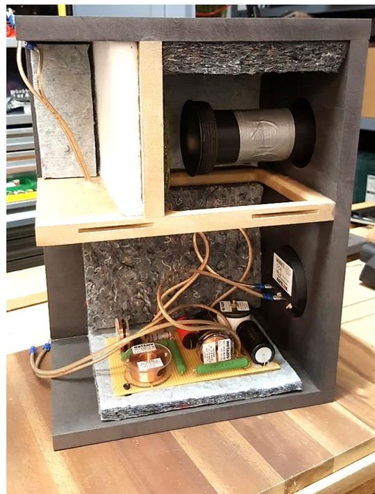
Abbildung 20: Schnittansicht zum Gehäuseaufbau und Innenansicht am Prototyp-Aufbau
